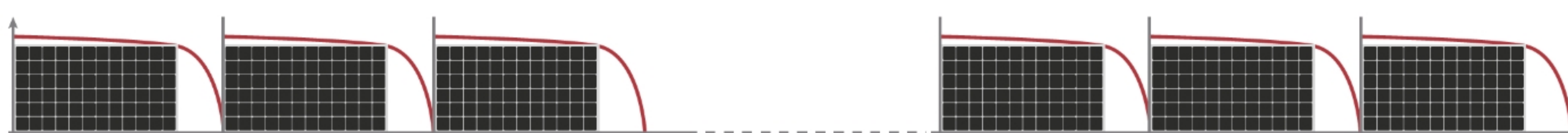
Konventionelles Modul: 20PCS/String (1100V Wechselrichter), 28PCS/String (1500V Wechselrichter)
